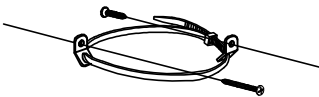
x1 RC-ANTI-TIP -Anti-tipping restraint * Liste des pièces de quincaillerie antibasculent Lista del kit de materiales antivuelco
