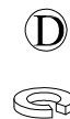
x14 Lock washer Ø5/16"x13mm* x14 Rondelle de blocage Ø5/16"x13mm x14 Arandela de Seguridad Ø5/16"x13mm
