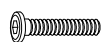
x14 Allen bolt Ø5/16"x18 x40mm * x14 Vis à tête creuse hexagonale Ø5/16"x18x40mm" x14 Perno Allen Ø5/16"x18x32mm
