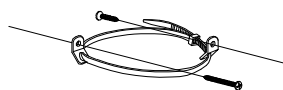
x1 RC-ANTI-TIP-Anti-tipping Restraint * Liste des pièces de quincaillerie antibasculment Lista del kit de materiales antivuelco
